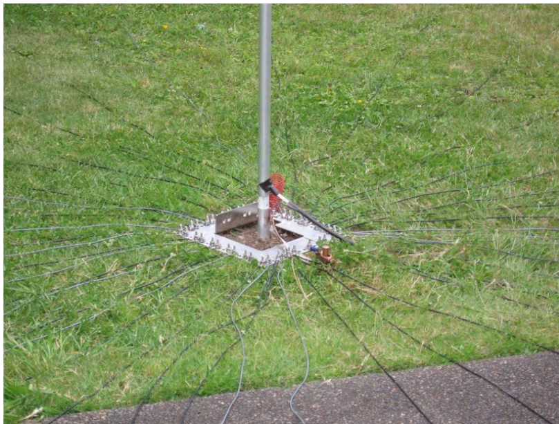
Múltiples radials en una antena vertical
